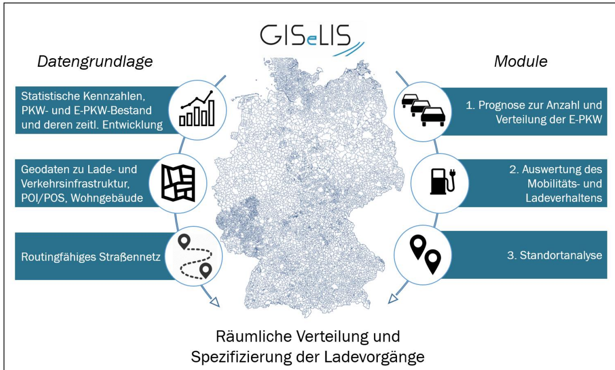
Abbildung 11: Funktionsweise des Standortmodelles für Ladeinfrastruktur GISeLIS
